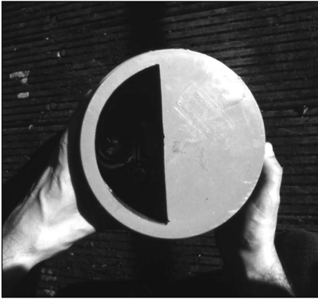
Abb. 2: PVC-Rohr mit eingebautem Camcorder. Fig. 2: PVC-pipe with the inserted camcorder.
